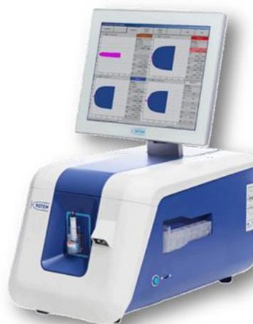
La provetta con sangue citratato si inserisce nell'apposito alloggiamento e si distribuirà nei canali di reazione
